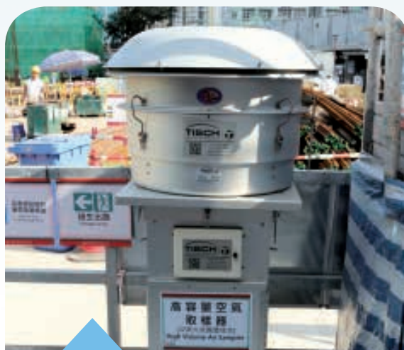
大容量空氣取樣器以監察工地的空氣質素
